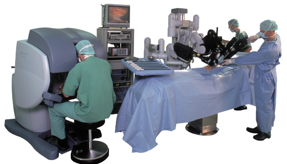
手術ロボット、ダ・ヴィンチでは左側の機器で医師が操作すると手術台側のアームが正確に動く
